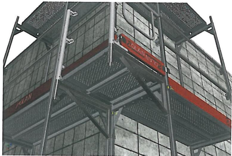
Le proiezioni possono anche essere collegate per mezzo di una mensola da 0,73 m e di un impalcato angolare, come mostrato di seguito. Nota: realizzare parapetti di sicurezza usando 2 tubi di 48,3 mm di diametro e giunti girevoli.
