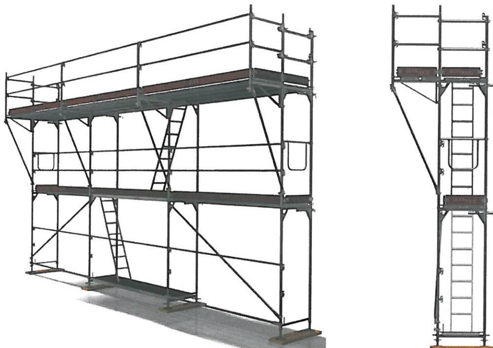
Il carico applicato all'area di lavoro ampliata utilizzando mensole, non può superare il carico consentito per l'impalcato principale. La staffa da 0,73 m può essere installata sull'ultima campata del piano sul lato esterno del ponteggio o su qualsiasi piano, a condizione che sia previsto un ancoraggio supplementare alla parete della campata con la staffa montata e alla campata sovrastante e a quella sottostante.
